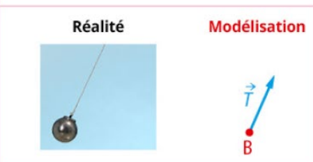
FIG. 8 Tension \vec{T} du fil modélisant l'action du fil sur une boule B qui y est accrochée.
